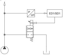
Un tel système permet de satisfaire à de hautes exigences dynamiques et statiques. On peut utiliser n'importe quelle valve proportionnelle avec une arête de commande active.
