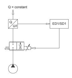
Un tel système permet de satisfaire à de hautes exigences dynamiques et statiques. On peut utiliser n'importe quelle valve proportionnelle avec une arête de commande active.
