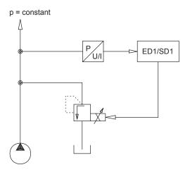
Ce système n'est qu' une poursuite électronique de la valeur de consigne. Le problème réside dans le fait que la pression est déjà réglée mécaniquement dans la valve. Ce réglage mécanique est très inerte, et la régulation électronique doit être ralentie artificiellement. (Régulation en cascade: la boucle externe doit être plus lente que la boucle interne). Avec un tel système, on peut satisfaire à de bonnes exigences statiques, mais les exigences dynamiques sont très mal remplies.
