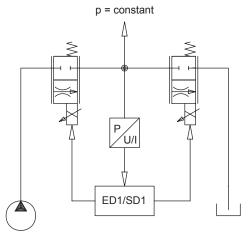
Un tel système permet de satisfaire à de hautes exigences dynamiques et statiques. On peut utiliser n'importe quelle valve proportionnelle avec une arête de commande active.
