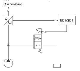
Un tel système permet de satisfaire à de hautes exigences dynamiques et statiques. On peut utiliser n'importe quelle valve proportionnelle avec une arête de commande active.
