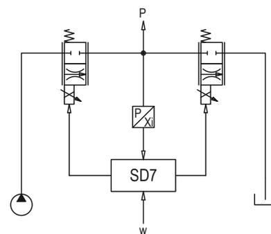
**Mode régulateur «Contrôle de la position de l'axe»**
