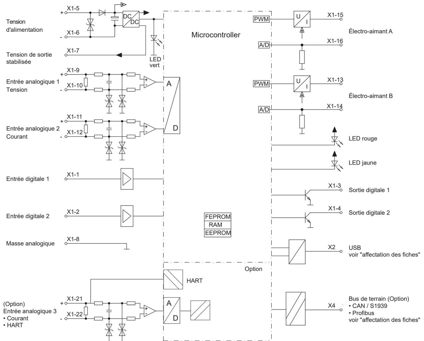
**Configuration des entrées analogiques Régulateur Basic**
