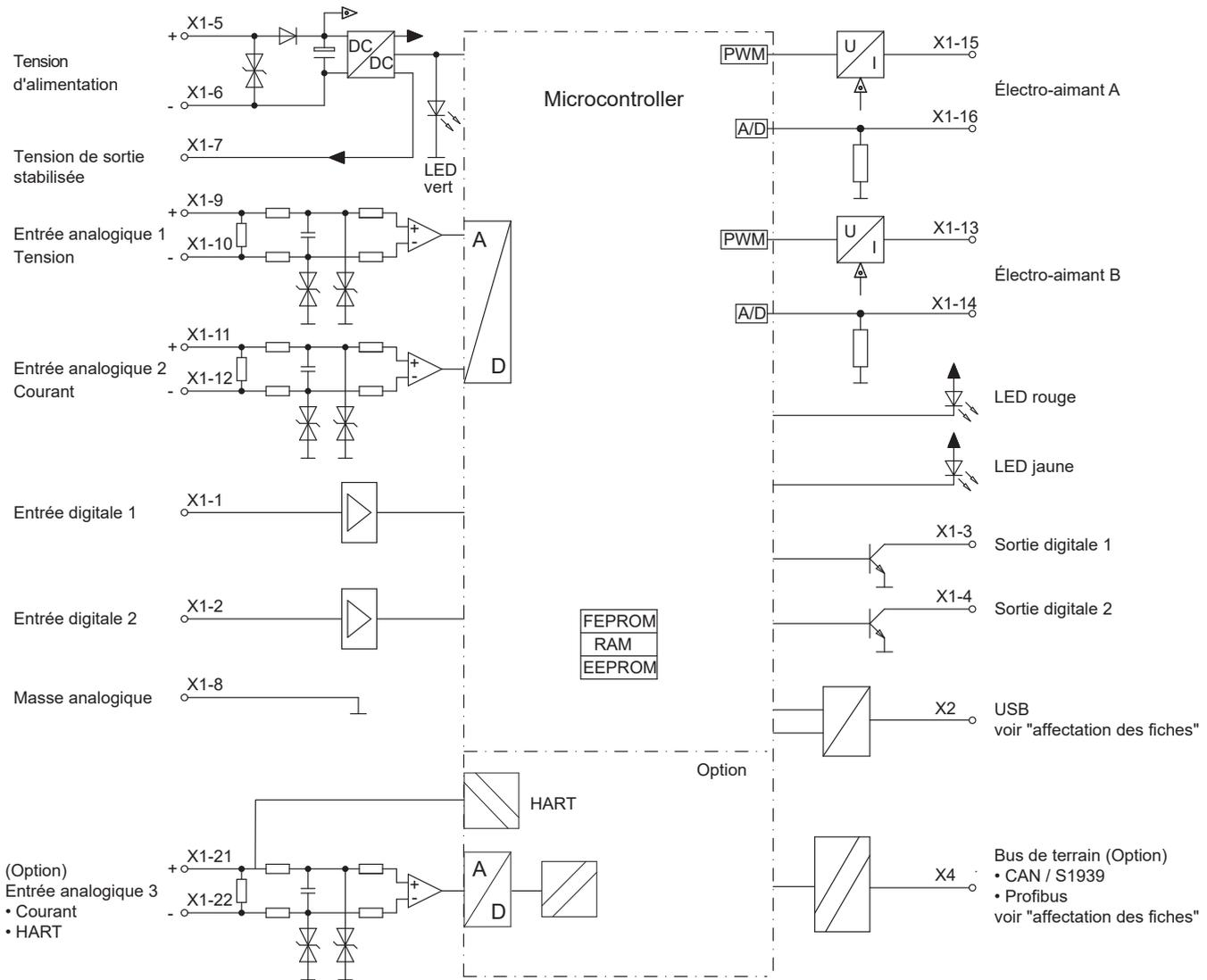
**Configuration des entrées analogiques Amplificateur Basic**
