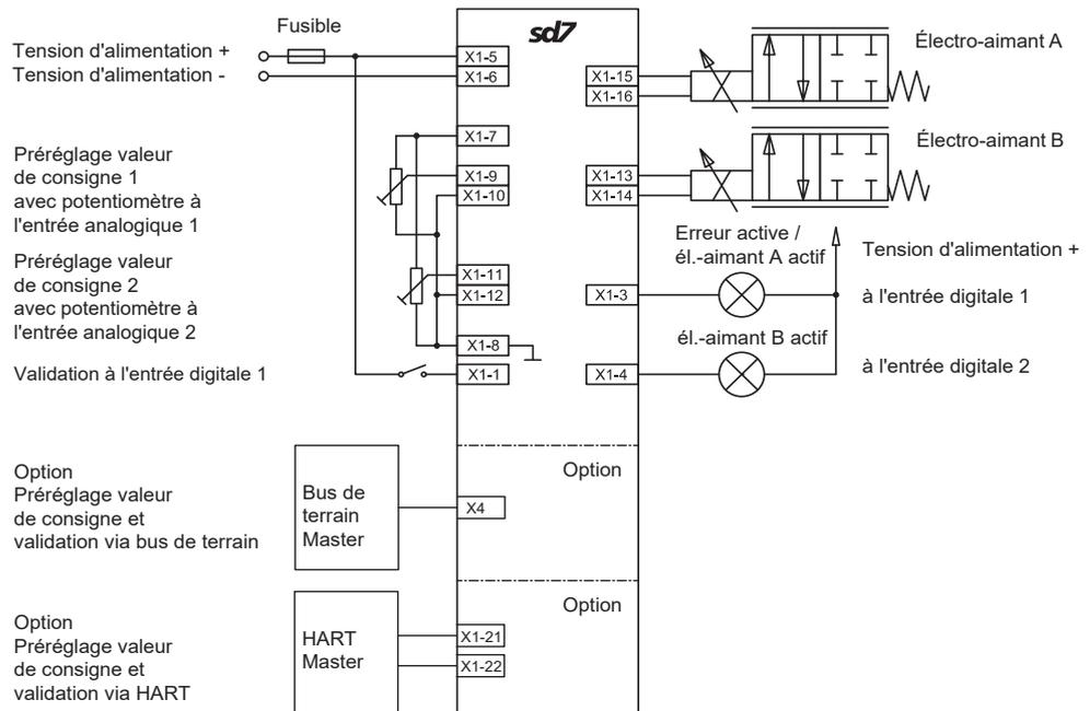
**EXEMPLE DE RACCORDEMENT AMPLIFICATEUR ENHANCED**
