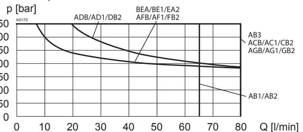
$\Delta p = f(Q)$  Druckverlust-Volumenstrom-Kennlinie
