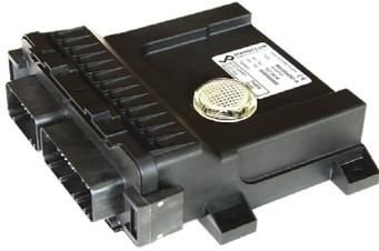
**MD2 Mobilelektronik** – Digitales Verstärker- und Reglermodul für den Einsatz in rauher Umgebung. IP67, CANopen – Feldbus, bis zu 8 Magnetausgänge für Steuerungs- oder Regelaufgaben, Sollwertvorgabe in Form von Spannung, Strom, Frequenz oder PWM.
