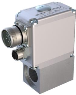
**DSV Verstärkerelektronik** – Digital Smart Valve mit digitaler Verstärkerelektronik zur Ansteuerung eines Proportionalventiles mit einem oder zwei Magneten. Plug & Play Lösung mit dem Ventil. Robust, IP67, Verstärker oder Regler, CANopen, J1939 oder Profibus DP.
